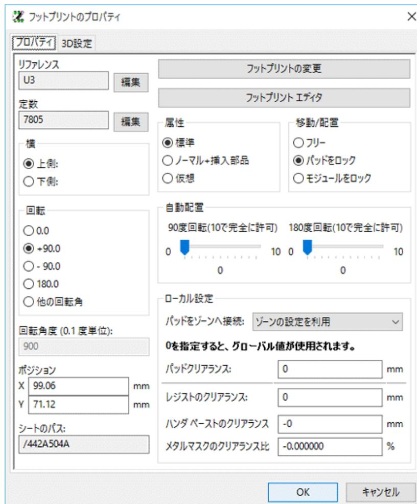
対象のフットプリントからフットプリントエディタを起動した場合、基板で使用中のフットプリントがフットプリントエディタに自動的に読み込まれ、直ちに編集または保存可能になります。
