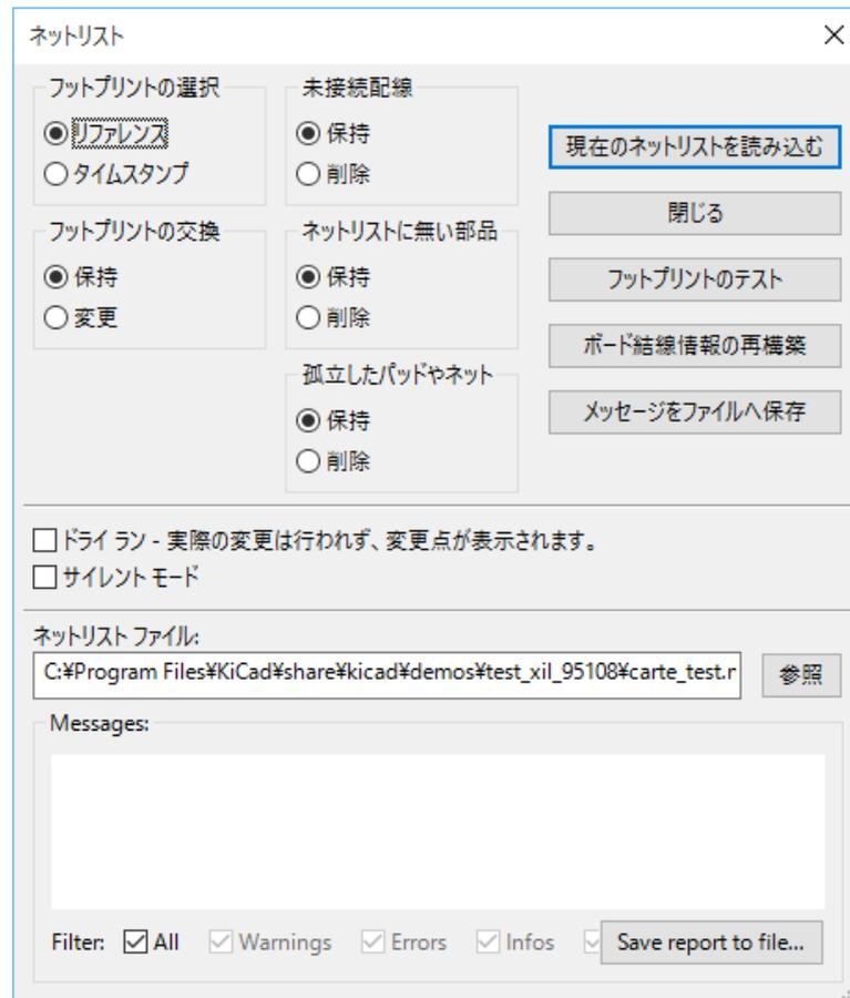
“ネットリストファイル” に表示されたファイル名が正しくない場合、“参照” ボタンを押して読み込みたいネットリストを選択します。それから“現在のネットリストを読み込む” ボタンを押します。既に読み込み済ではない全てのフットプリントが重なって画面に現れるでしょう（それらを自動的に移動させる方法を次に示します）。
