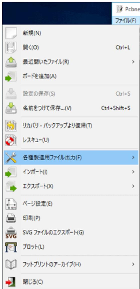
ファイルメニューではプリント基板の印刷、プロットだけでなく、プリント基板ファイルの読み込み、書き込みができます。自動テスターで使用する回路を出力（GenCAD1.4 形式）することもできます。
