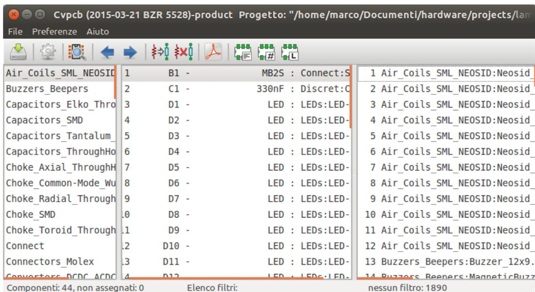
Filtrato per elenco di filtri di impronte assegnati al componente selezionato. I filtri componente sono elencati nel pannello centrale della barra di stato in fondo alla finestra principale.
