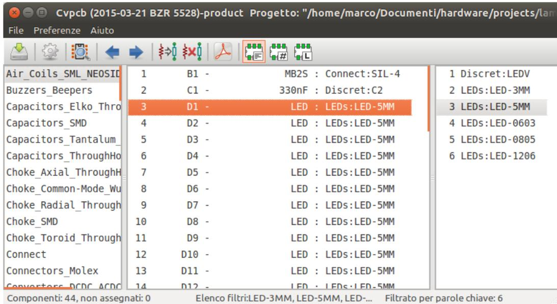
Nell'editor delle librerie di componenti in Eeschema, l'elenco di impronte era stato impostato usando le voci nella scheda filtro impronte della finestra di dialogo delle proprietà del componente, come mostrato in basso.
