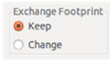
Le changement d'une empreinte (par exemple, le remplacement d'une résistance par une autre de taille différente), peut être effectué directement en éditant l'empreinte.
