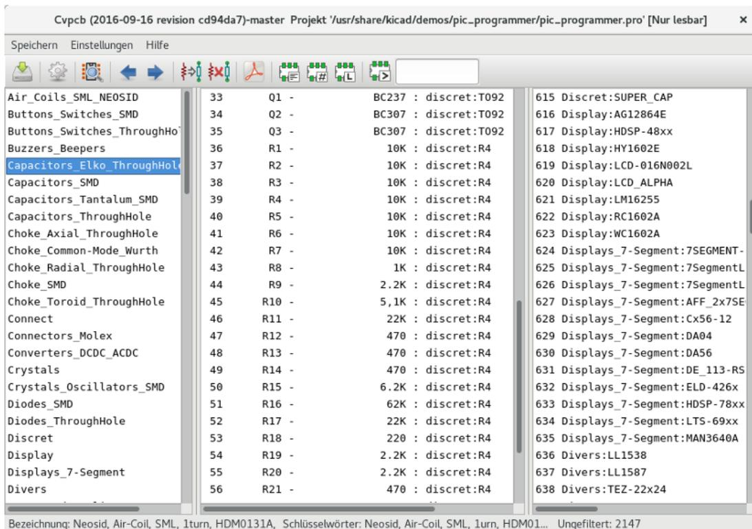
Gefiltert wird anhand der Liste von Footprintfiltern die dem ausgewählten Bauteil zugewiesen sind. Die Bauteilfilter sind im mittleren Bereich der Statusleiste am unteren Rand des Hauptfensters angezeigt.
