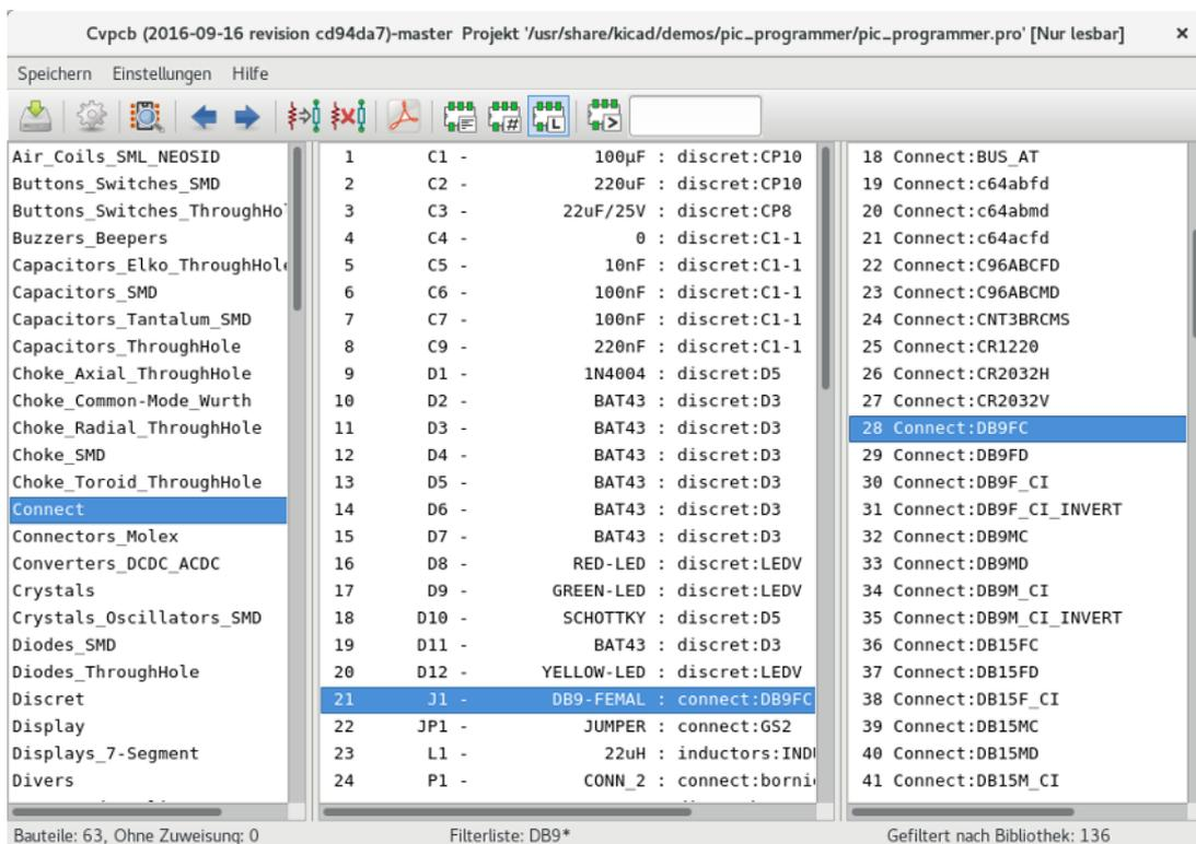
Die Filter können kombiniert werden, um komplexere Filter zu bilden, wodurch die Anzahl der im Footprintbereich angezeigten Footprints sich weiter reduzieren.
